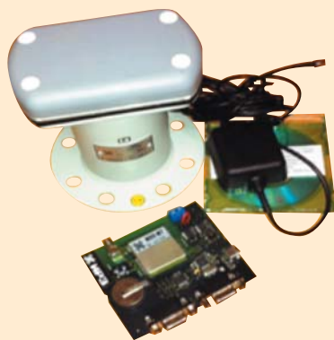
Рис. 11. Одночастотный 24-канальный ГЛОНАСС/GPS-приемник МНП-М7 производства Ижевского радиозавода
