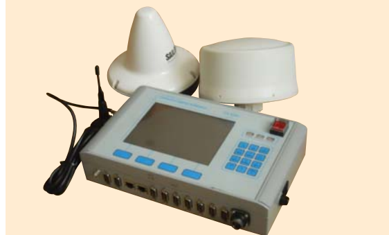
Рис. 3. Навигационная аппаратура со встроенным приемником дифференциальных поправок и функциями управления внешними комплексами и системами связи для целей мониторинга и информационно-навигационного обеспечения речных и морских судов SH-5703 (КБ НАВИС)
