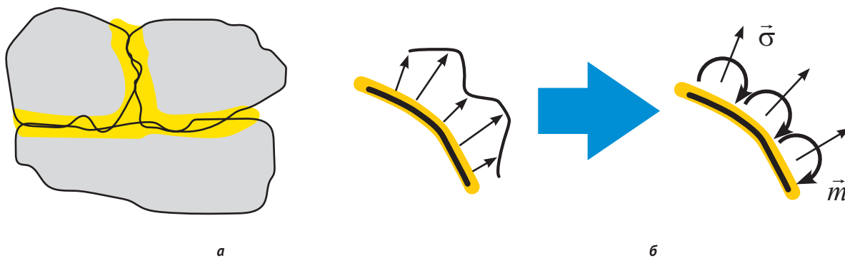
Рис. 6. Фрагмент гранулированной среды (а) и распределение поверхностных сил (б) Fig. 6. Fragment of a granular medium (a) and distribution of surface forces (b)
