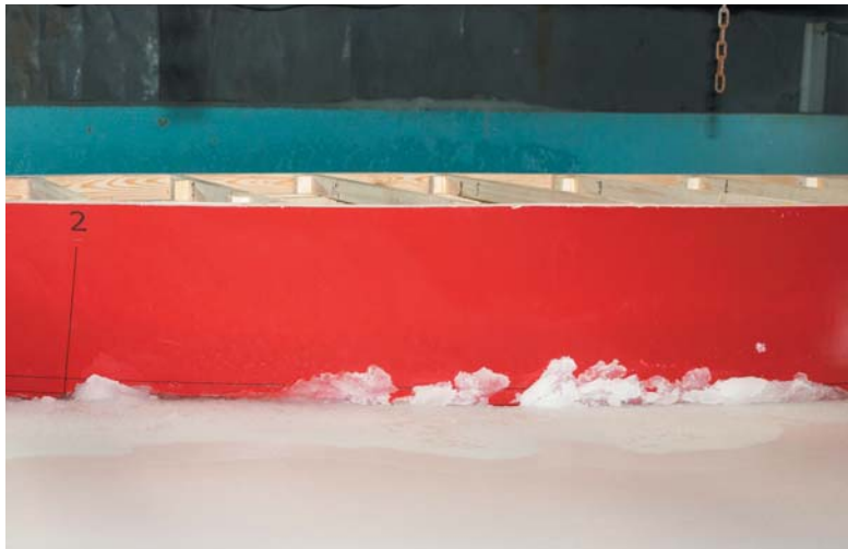
Рис. 4. Пример разрушения кромок канала смятием с образованием ледяной крошки вдоль борта
