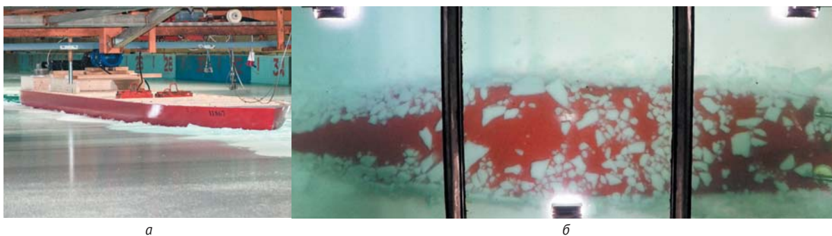
Рис. 2. Движение оптимизированной модели в канале за ледоколом ЛК-60. Вид сверху (а) и снизу (б)
