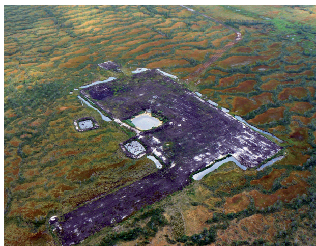
Геологоразведочная площадка. Выполнен технический этап рекультивации
