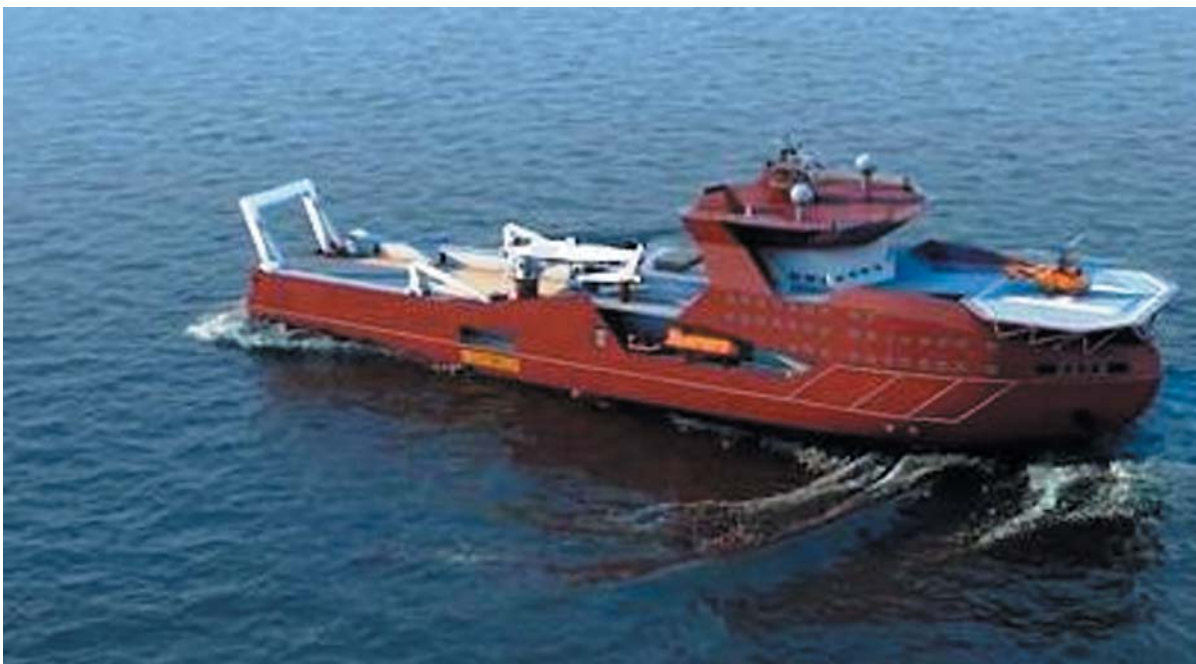
Рис. 6. Многофункциональный атомный ледокол-снабженец с функциями буксировки и якорезаводки (Icebreaker — Anchor Handling Tug & Supply Vessel)
