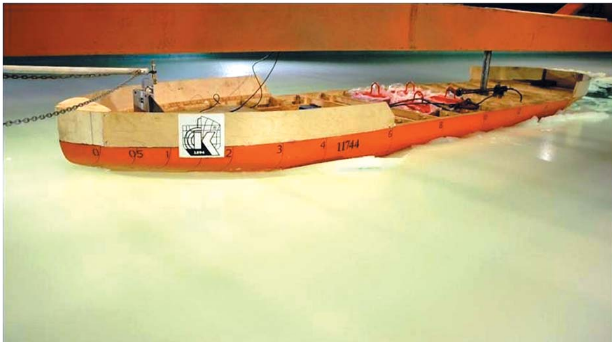
Рис. 1. Испытания модели корпуса ледокола-лидера в ледовом бассейне ФГУП «Крыловский государственный научный центр»
