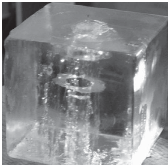
Рис. 7. Плоская кольцевая трещина при разгрузке образцов (нагрузка на индентор сверху вниз). Диаметр внутреннего отверстия в кольцевой трещине близок к диаметру индентора
