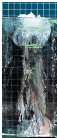
Рис. 6. Картина разрушения льда (финальная стадия) при квазистатическом нагружении индентором диаметром 10 мм
