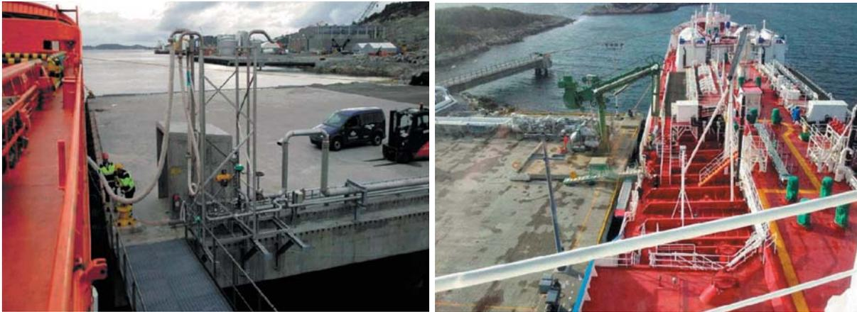
Рис. 5. Бункеровка СПГ [2]: а – бункеровка с помощью шланга, б – бункеровка с помощью наполнительных рукавов
