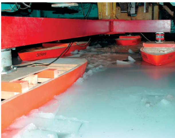
Рис. 6. Модельные испытания нового многокорпусного ледокола в ровных льдах
