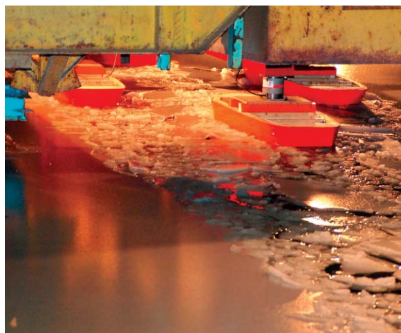
Рис. 7. Канал в ровных льдах, создаваемый новым многокорпусным ледоколом
