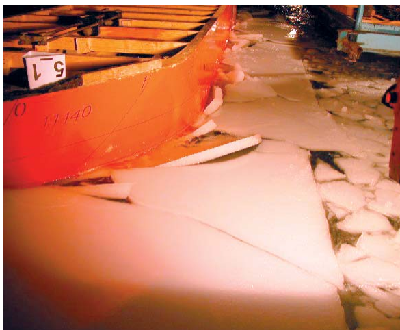
Рис. 4. Движение модели крупнотоннажного судна параллельно каналу, проложенному танкером
