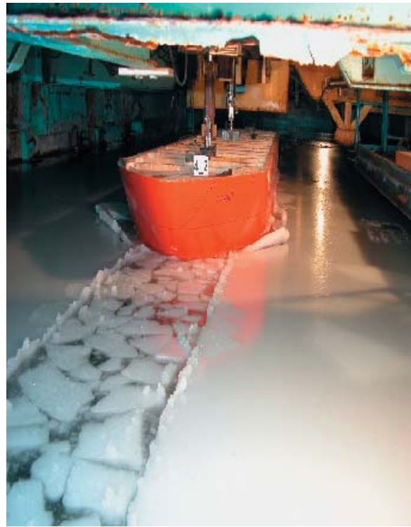
Рис. 3. Движение модели крупнотоннажного судна по каналу, проложенному ледоколом
