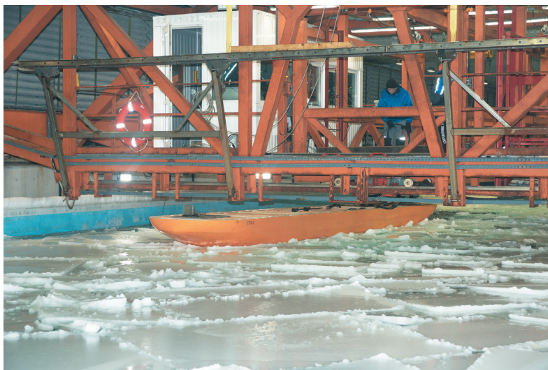
Рис. 4. Движение модели крупнотоннажного судна в сплоченных полях в режиме свободного самохода
