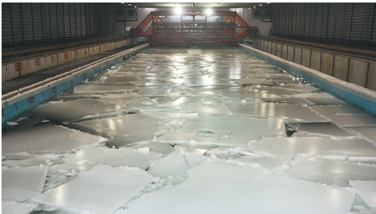
Рис. 3. Движение судна в поле сплоченного льда в ледовом бассейне Fig. 3. The ship model towing in the field of compacted ice in the ice tank
