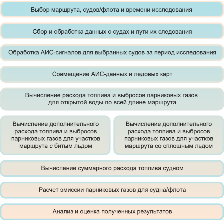
Рис. 3. Методология оценки выбросов парниковых газов судами при движении во льдах Fig. 3. Methodology for estimating greenhouse gas emissions from ships moving in ice
