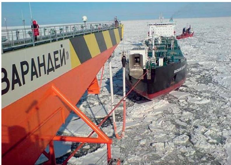
Рис. 4. Танкер типа «Василий Динков», швартуемый к Варандейскому ледостойкому терминалу
