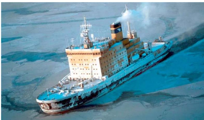
Рис. 3. Ледокол «Капитан Николаев», переоборудованный для обеспечения зимней отгрузки нефти танкерами типа «Астрахань»
