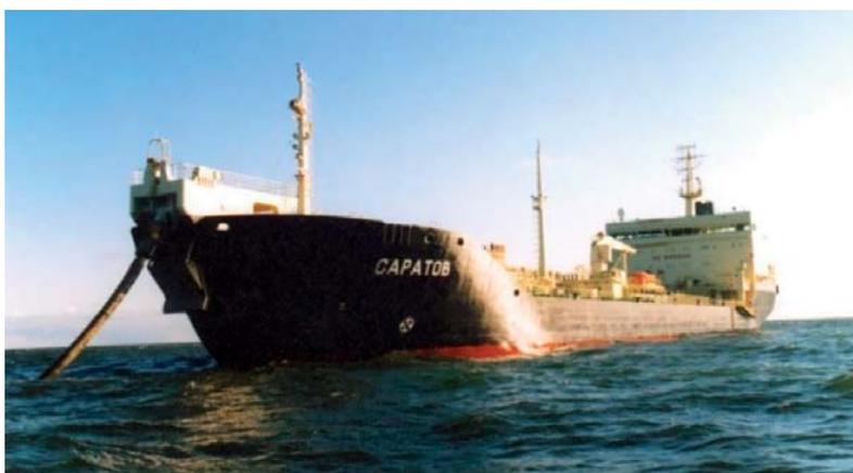
Рис. 2. Танкер типа «Астрахань», присоединенный к подводному терминалу бронированным шлангом
