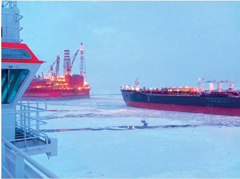
Рис. 6. Подход танкера типа «Михаил Ульянов» к платформе «Приразломная» для отгрузки нефти
