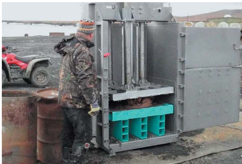
Рис. 8. Прессование бочкотары на специальном оборудовании
