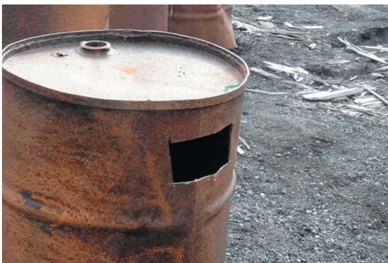
Рис. 5. Вырезанное шлифмашиной в верхней части боковой стенки бочки отверстие
