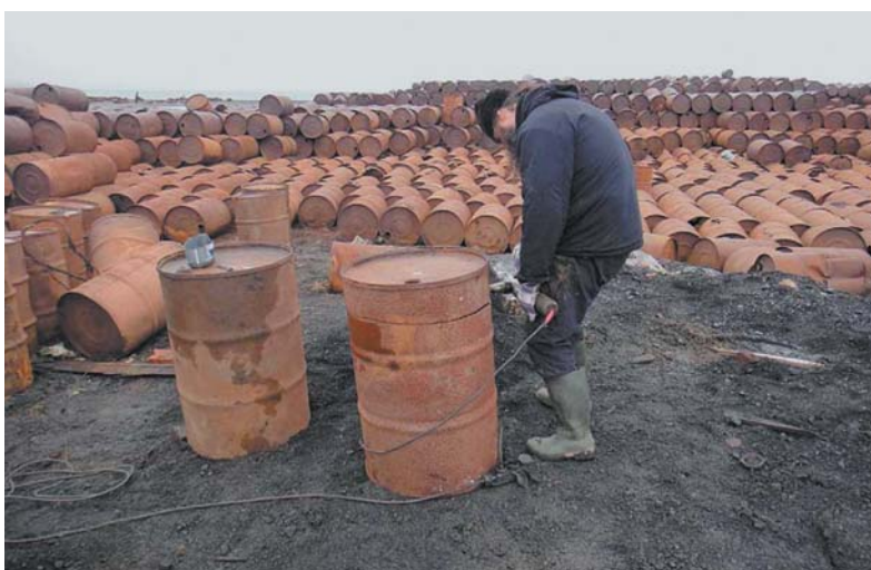
Рис. 6. Удаление верхней крышки бочки с помощью электроножниц
